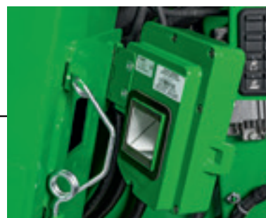
Kamera ActiveVision™ v kláskovém dopravníku umožňuje v reálném čase sledovat a analyzovat obsah omlatu.
