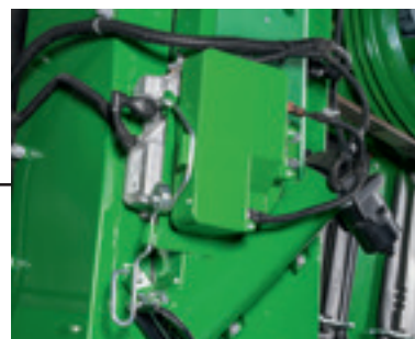
Kamera ActiveVision™ v zrnovém dopravníku sleduje kvalitu zrna v zásobníku.
