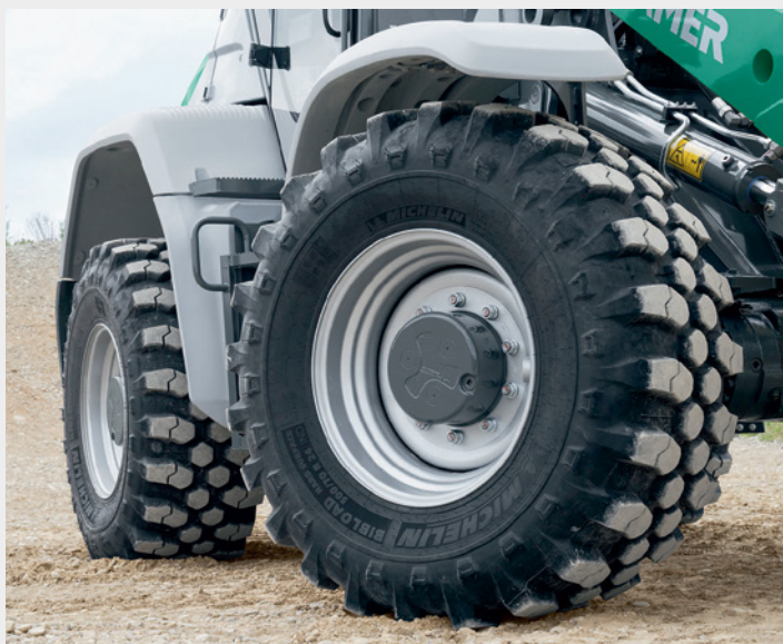
Řízení předních kol ideální pro provoz na komunikacích a s přívěsem
